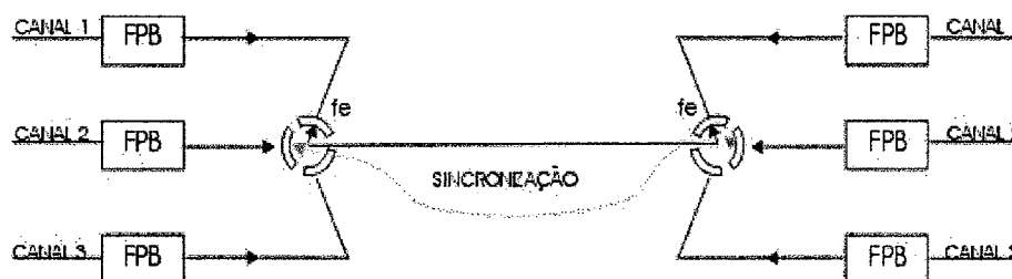
Fig. 06 – Multiplexação Por Divisão do Tempo – Amostragem - (Redes de Computadores – Das Lans, Mas,Wans às Redes ATM)
