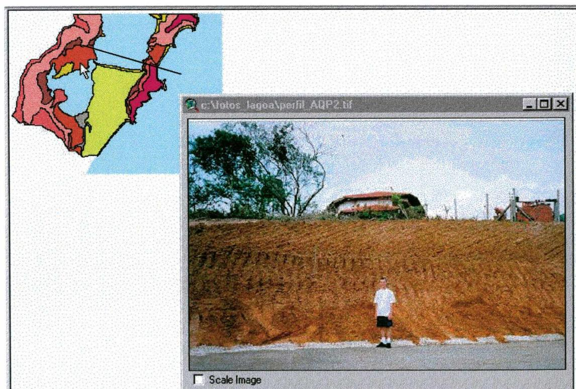
Figura 5.9 - Unidade Geotécnica AQP2 - Areia Quartzosa Podzolizada com substrato Sedimentos Quaternários (perfil).
