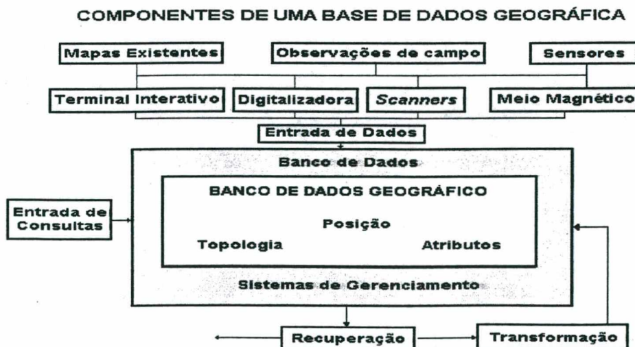
Fig. 4.10.1. – Estrutura de uma Base de Dados Geográfica (BURROUGH, 1994)
