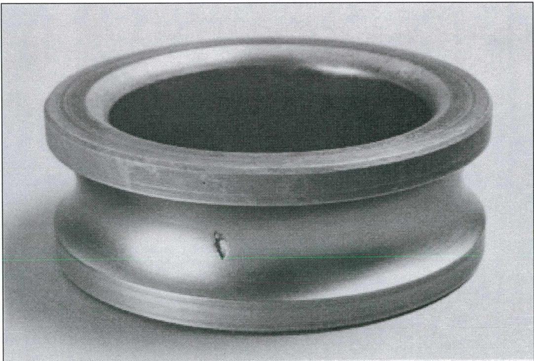
Figura 4. 2- Pista interna com trinca por fadiga[LEENDERS[1983]]
