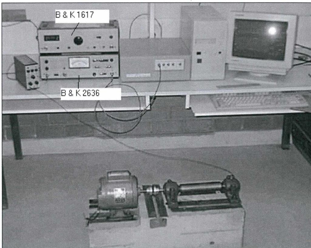
Figura 6 14- Cadeia de medição da técnica do envelope
