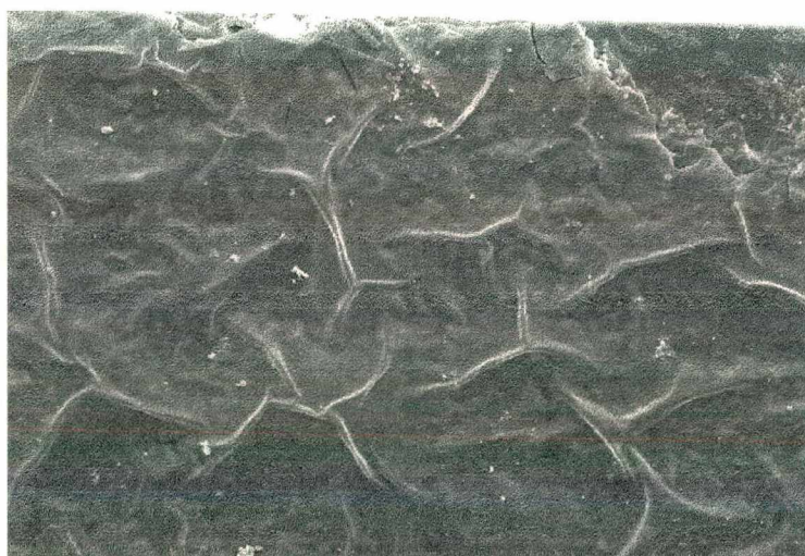
FIGURA 29(B): Micrografia de MEV de um eletrodo de placa de Pt, revestido galvanostaticamente por poli- \{trans-[RuCl_2(pmp)_4]\} . Aumento: 400x. Feixe de energia: 20.0 kV.
