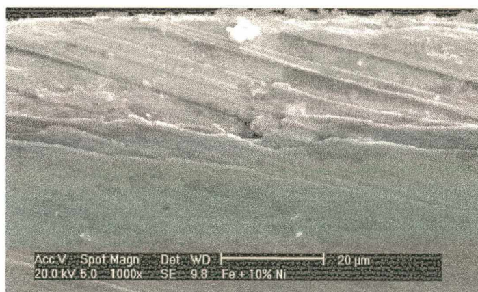
FIGURA 50(B): Micrografia de eletrodo Fe+10%Ni. Corte transversal mostrando a interface substrato-filme.
