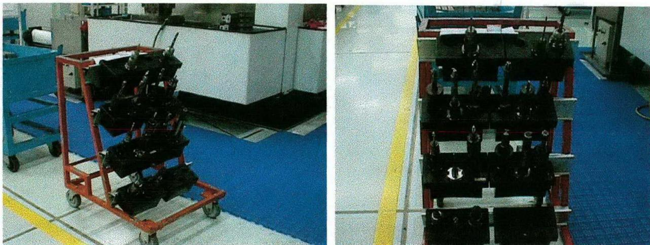
**FIGURA 11** - Carrinho para transporte de ferramentas até a máquina
