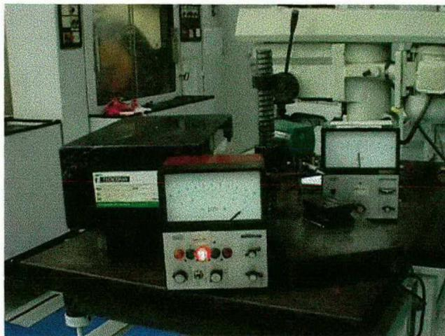
**FIGURA 19** - Rugosímetro e base de verificação de planicidade
