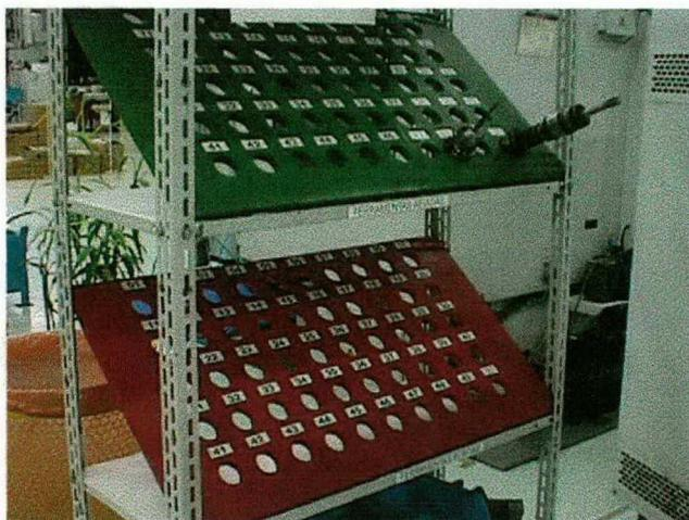
**FIGURA 22** - Estante para colocação de ferramentas afiadas e para Afiar
