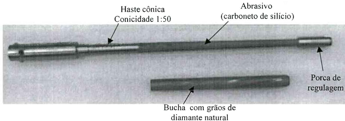
Figura 8.4 – Componentes e detalhes construtivos da ferramenta utilizada
