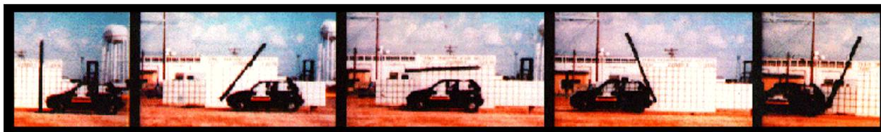
**FIGURA 4.7** - Foto-seqüência de um teste de colisão do Ford Fiestiva contra um suporte deformável a 60 mph (96,5 km/h), resultando apenas em danos materiais superficiais.
