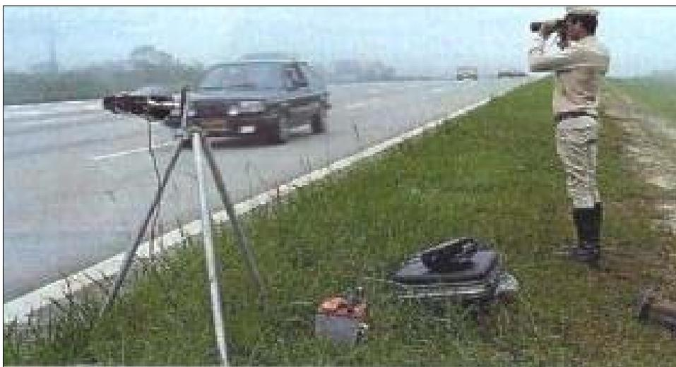
**FIGURA 4.1** - Radar de microondas
