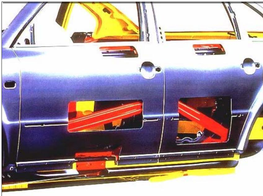
**FIGURA 5.7** - Detalhes das barras de reforço lateral colocadas no interior das portas do veículo e apoiada sobre as colunas
