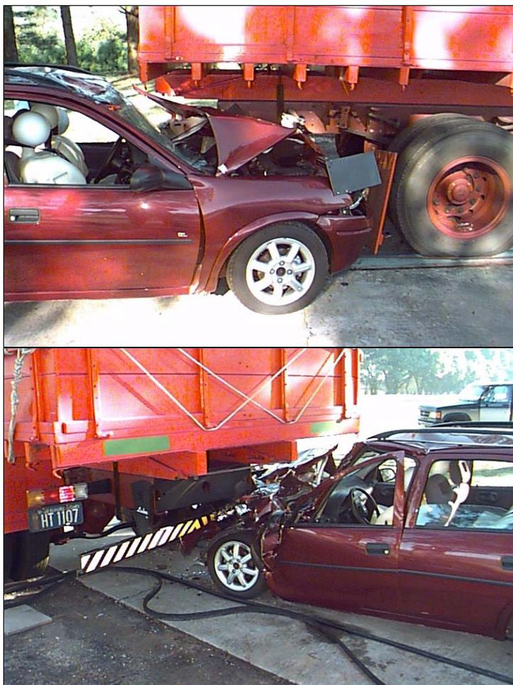
**FIGURA 5.3** - Testes de colisão com o pára-choque atendendo à resolução 805/95 - (Projeto impacto, 1998)
