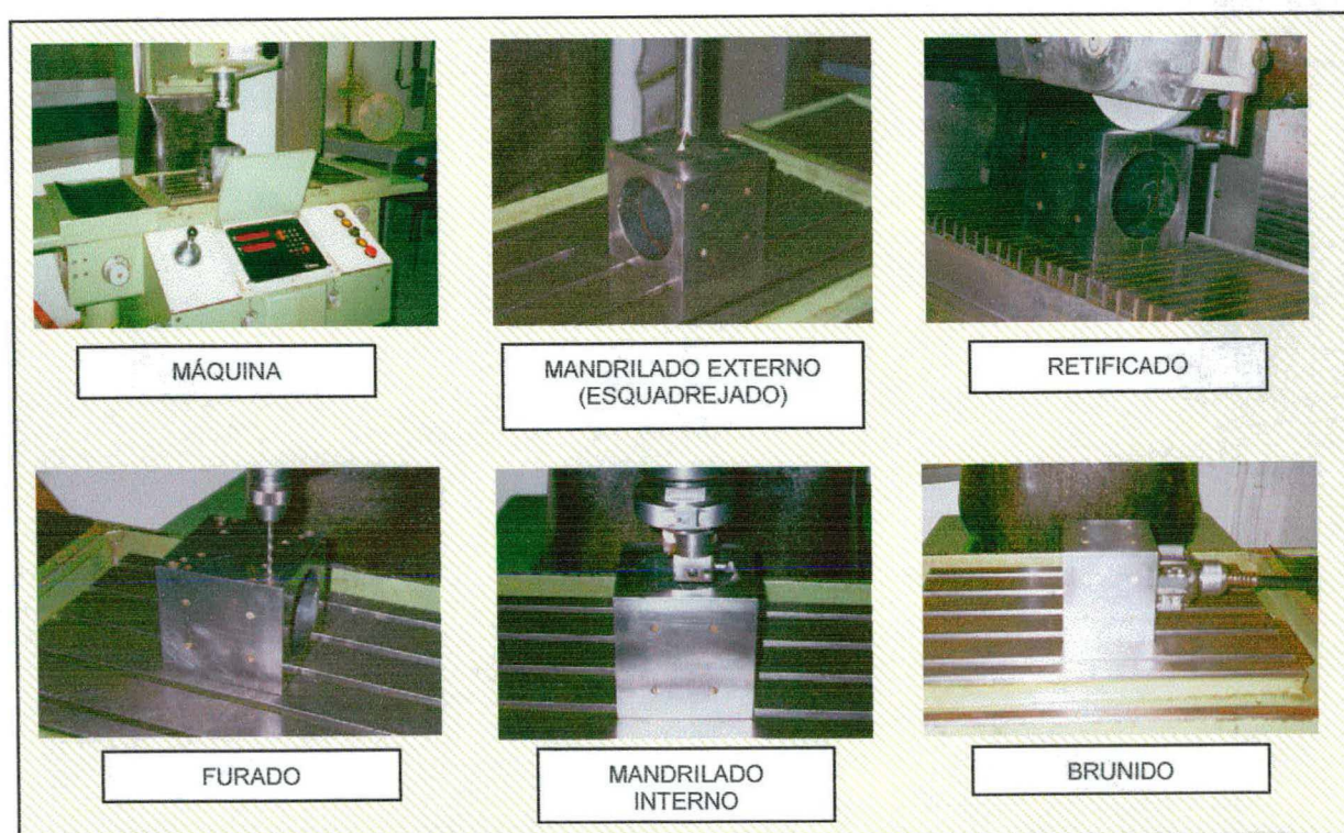
Figura 3.14 –Seqüência de fabricação dos mancais aerostáticos.
