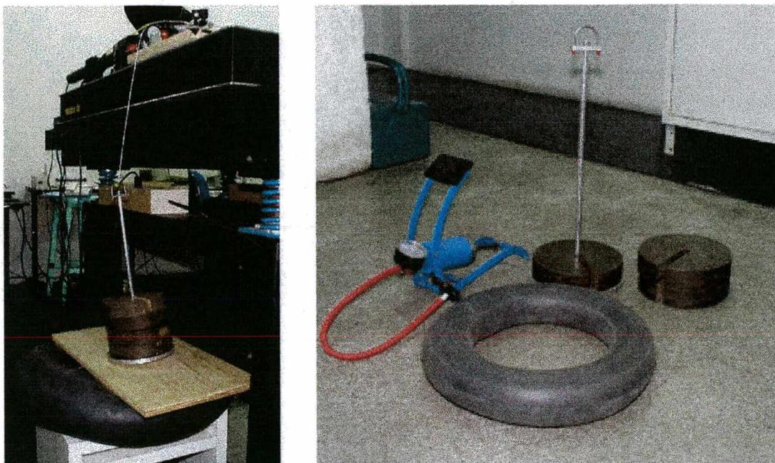
Figura 4.21 - Sistema de Tração: suporte, massas e dispositivo para aplicar a carga aos corpos de prova.
