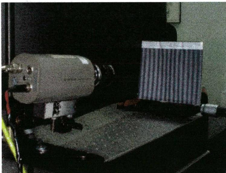
**Figura 5.5** - Configuração adotada na calibração do Conta Franja.
