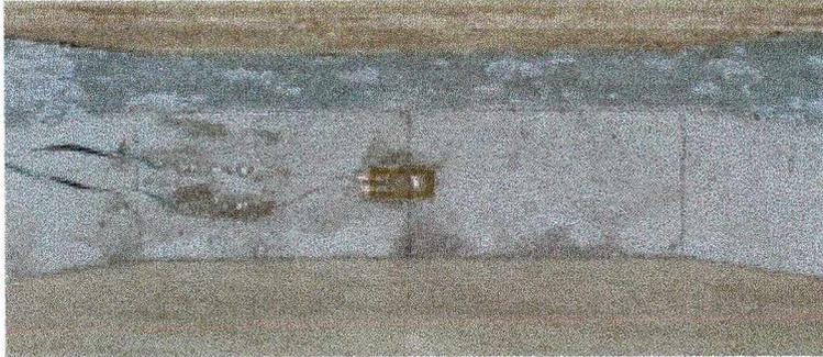
**Figura 5.2** - Corpo de prova instrumentado com extensômetros na região de deformação constante.
