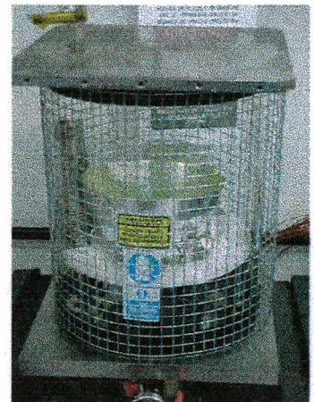
Figura 56 – RCP de três estágios montado sobre a bancada de testes ( esquerda ); camisa de LN_2 e sistema de vácuo ( centro ); camisa de LN_2 montada e pronta para experimentos dentro da câmara de vácuo ( direita ).
