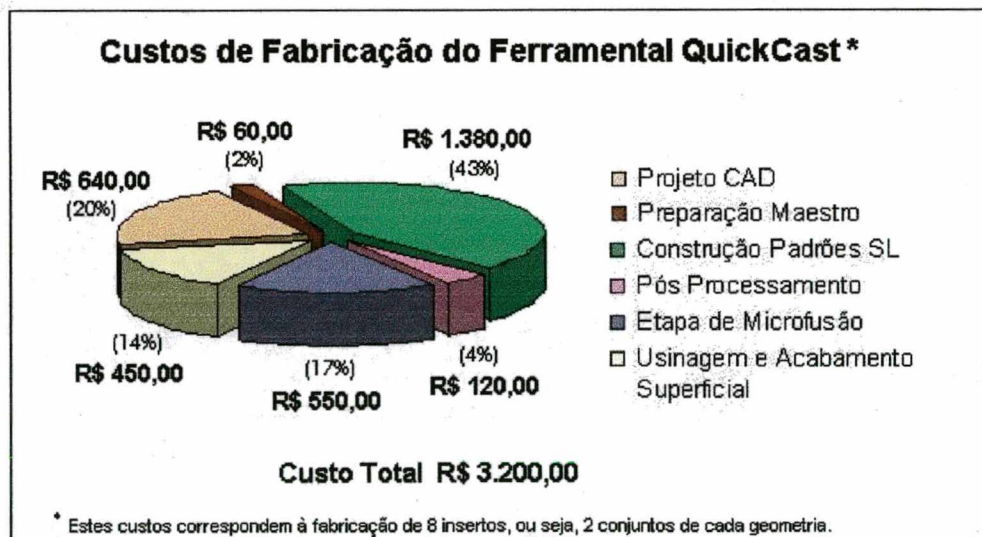
Figura 65 – Diagrama de custos de fabricação do ferramental QuickCast™
