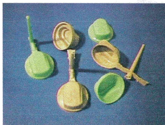
Figura 59 – Peças injetadas nos insertos QuickCast tooling
