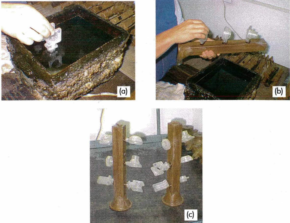
Figura 48 – Montagem dos padrões Quickcast™ nas árvores de cera.
