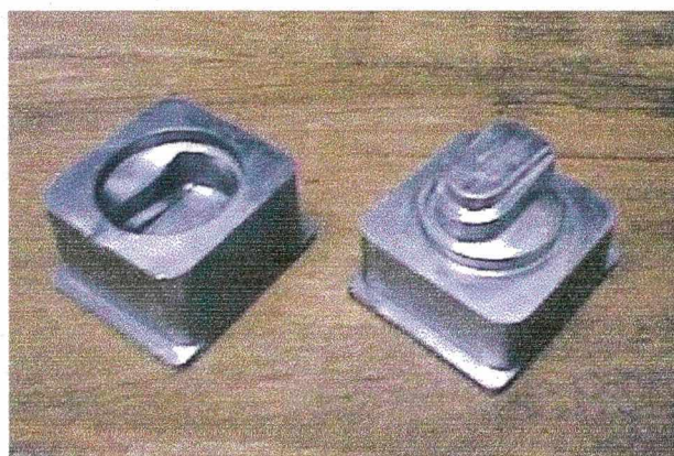
Figura 58 – Insertos QuickCast após acabamento superficial
