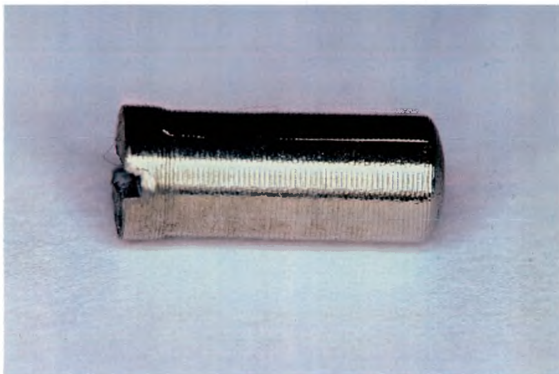
Figura 8 – Amostra do implante do grupo 4 ( f=0,15\text{mm} )
