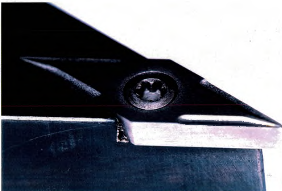
Figura 1 – Ferramenta para o desbaste inicial
