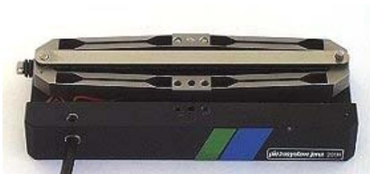
Figura 4.25 – Microposicionador de curso longo (1500 \mu m) (Piezojena, 2000)
