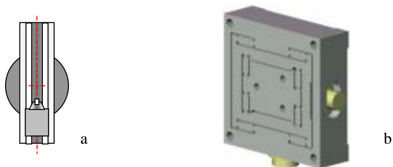
Figura 3.10 – a) Guia montada e alinhada sobre base \theta , b) Fixação do porta-ferramenta sobre um dispositivo intermediário para ajustagem (Base X-Y)
