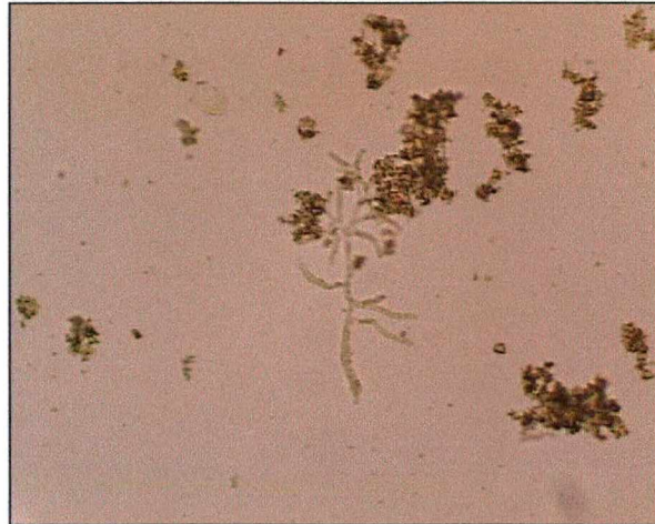
Figura 5.18 – Flocos em suspensão com Zooglea spp (x 100)
