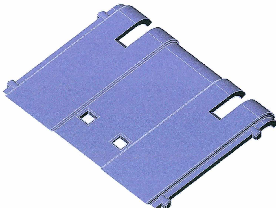
Figura 4.6 - Componente número três do conjunto de guias para a máquina destinada à automação bancária.
