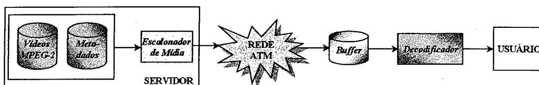
Fig. 7.2 – Transmissão do Fluxo MPEG-2 em Redes ATM
