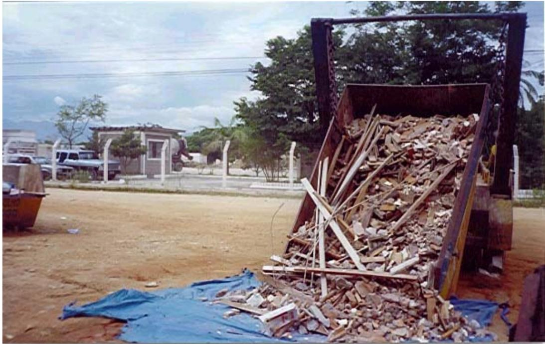
FIGURA 4.3- Contêiner sendo virado pelo caminhão coletor
