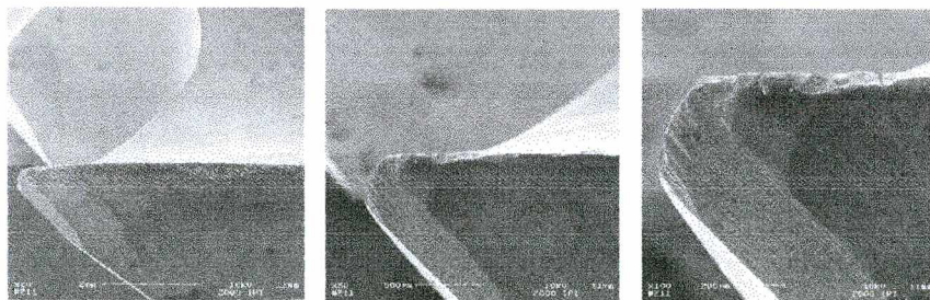
Figura 7.12. Desgaste e lascamento do gume da fresa de topo reto no ensaio com aço temperado na condição 3.
