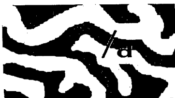
Figura 13: Estrutura co-continua da SD e a distância entre fases "d".
