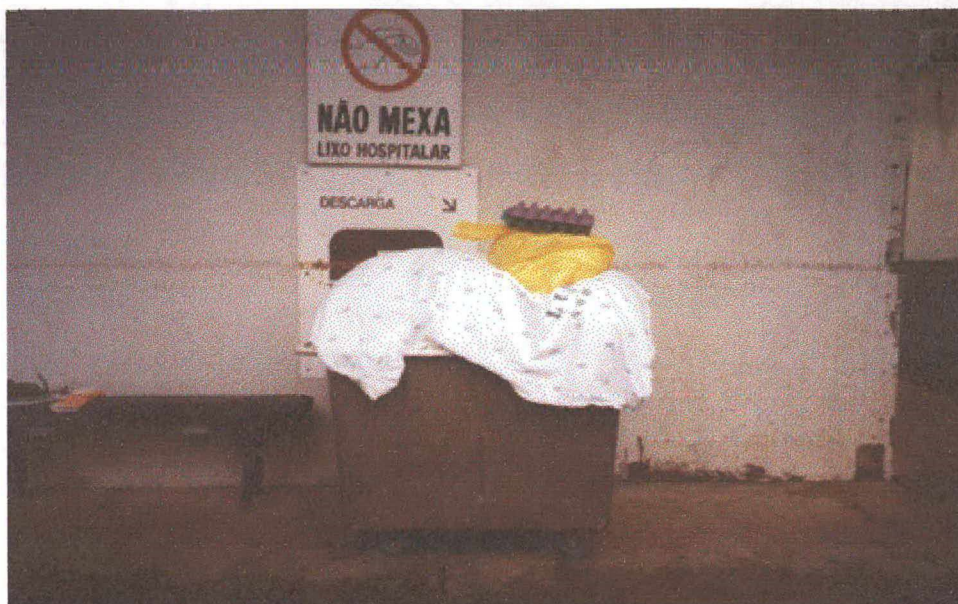
Figura 10: Carrinho para coleta de resíduos na forma retangular e de fibra de vidro
