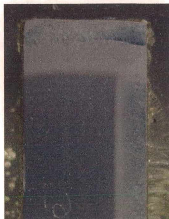
Fig. 109- Macrografias de seções longitudinais aos dois cordões de solda, realizadas nos cilindros de implante (em aço A516 Gr.70). Nessas seções foram levantados os perfis de dureza.
