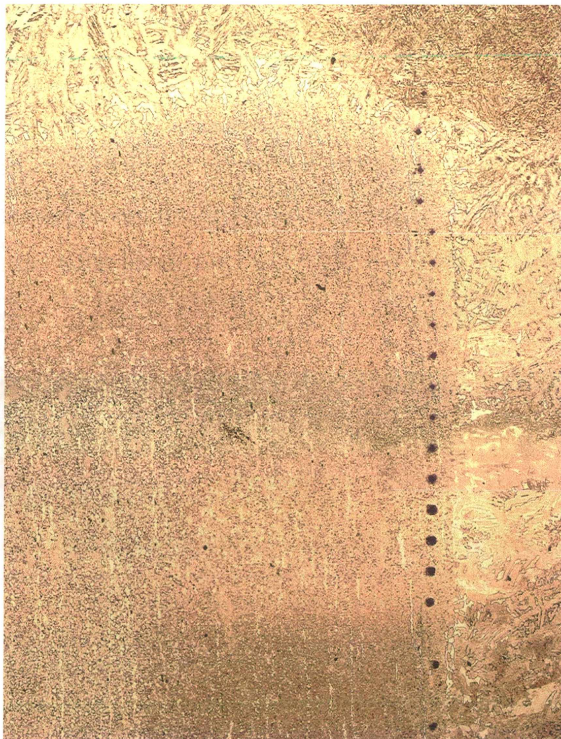
Fig. 84- Micrografia geral da amostra de implante, indicando os valores de dureza medidos e as correspondentes temperaturas T_p estimadas.
