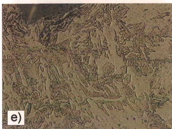
Fig. 68- Microestruturas de amostras submetidas a tratamentos isotérmicos: a) a 700 °C; b) a 800 °C; c, d, e) micrografias com maior resolução da ZTA-GG após ser tratada a 600, 700 e 800 °C, respectivamente.
