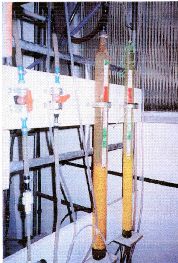
Figura 16: Foto das colunas de floculação.
