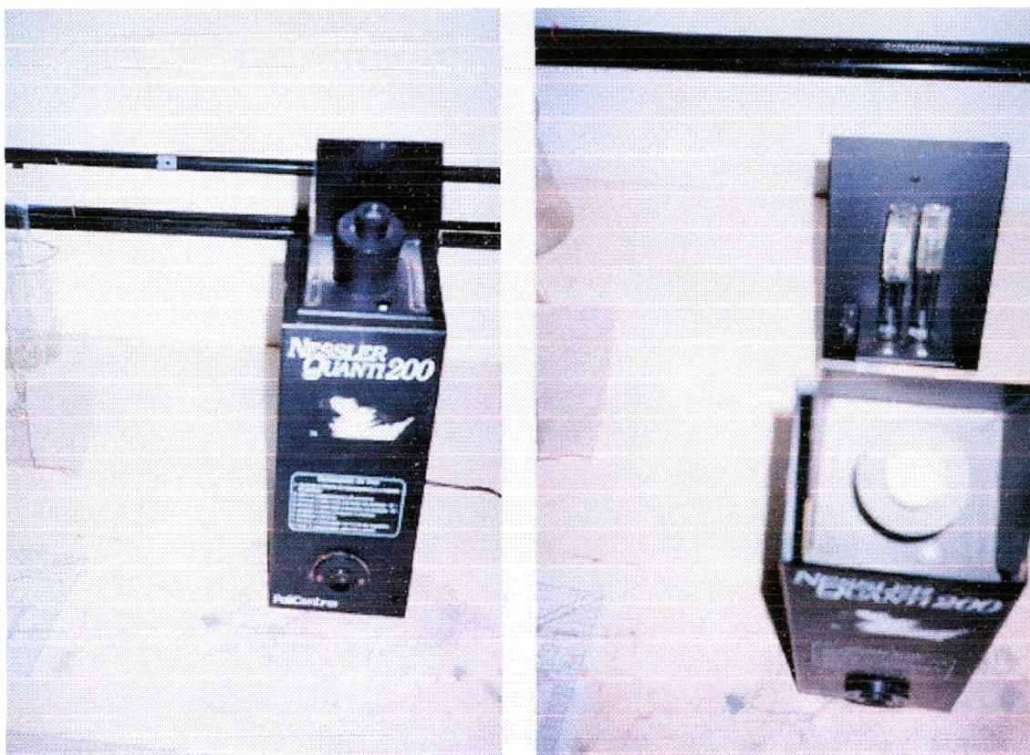
Figura 21: Foto do colorímetro NESSLER QUANTI 2000.
