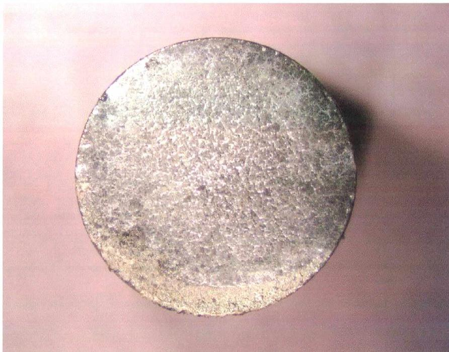
**Figura 37: Molhamento com a liga Ag-Cu sobre revestimento de Ti puro.**
