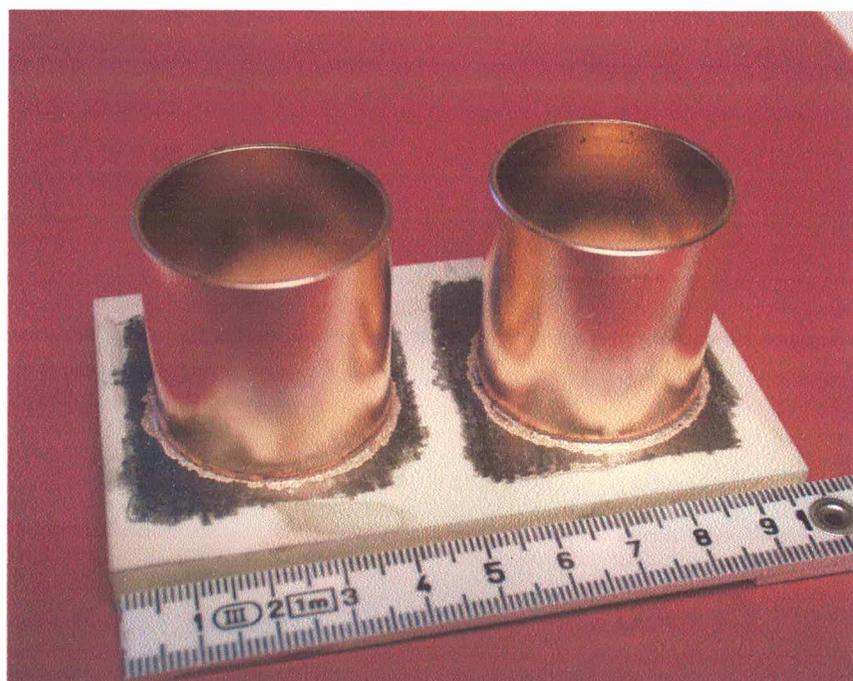
**Figura 52: União entre placa de Al<sub>2</sub>O<sub>3</sub> e tubos de Cu brasadas a 820 °C com a liga Ag-Cu. Metalização com Ti puro.**
