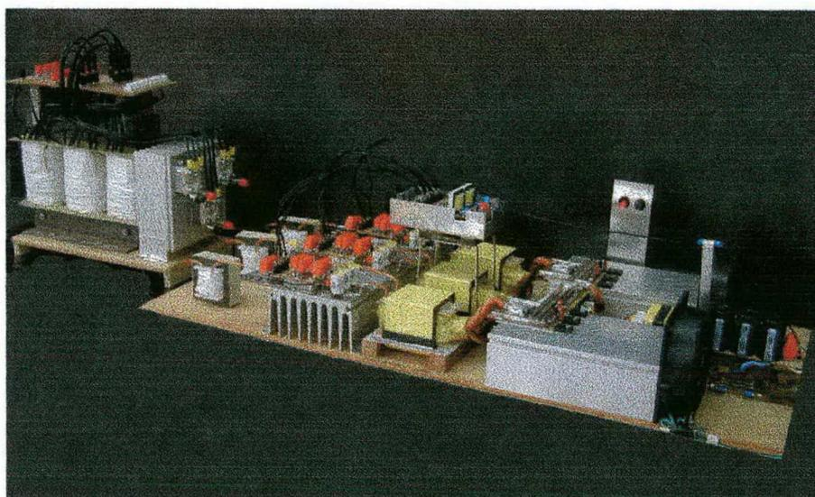
**Fig. 8.9 – Conversor CA-CC de 12 kW implementado.**
