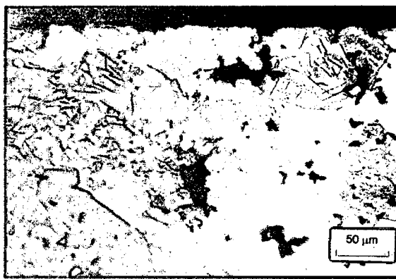
Fe-sinterizado, nitretado em 70%N 2 +30%H 2 ; 1h; 2,5 Torr; 2 cm 3 /s; 540°C.
