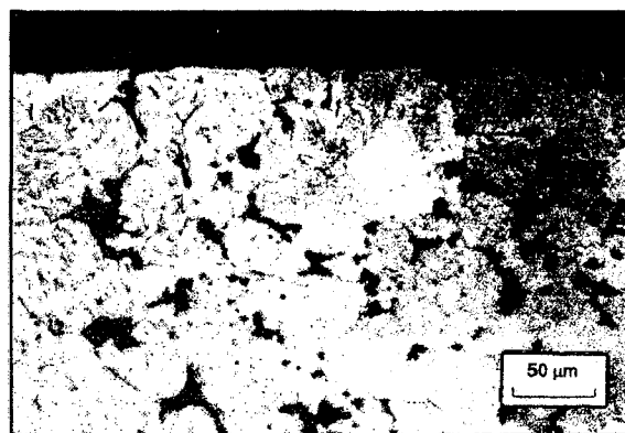
(b) Fe-sinterizado, nitretado em 96\%N_2+4\%H_2 ; 1h; 2,5 Torr; 2\text{ cm}^3/s ; 540^\circ C .
