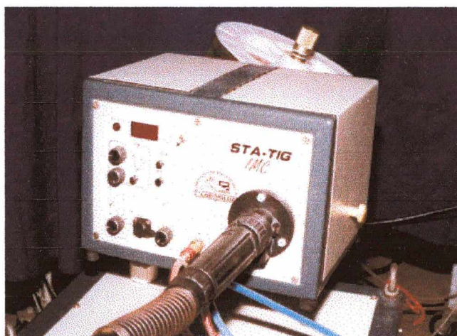
Figura 3.1 – Cabeçote Alimentador Automático de Arame (STA-TIG), desenvolvido no LABSOLDA / UFSC e utilizado neste trabalho.
