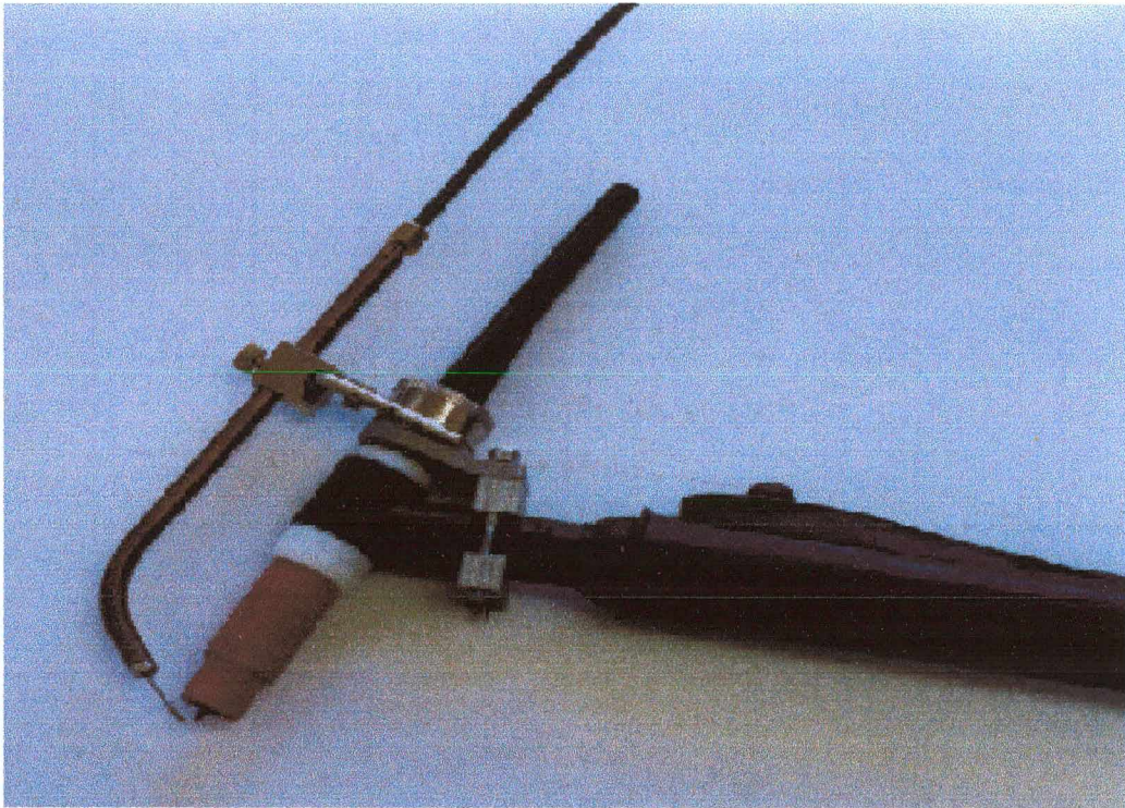
Figura 3.2 – Tocha TIG adaptada para alimentação automática de arame.
