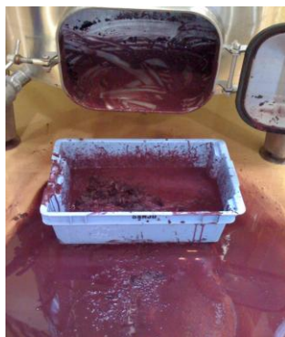
Figura 23. Retirada da borra em caixa plástica após trasfega. Fonte: Betina P. de Bem (2012).
