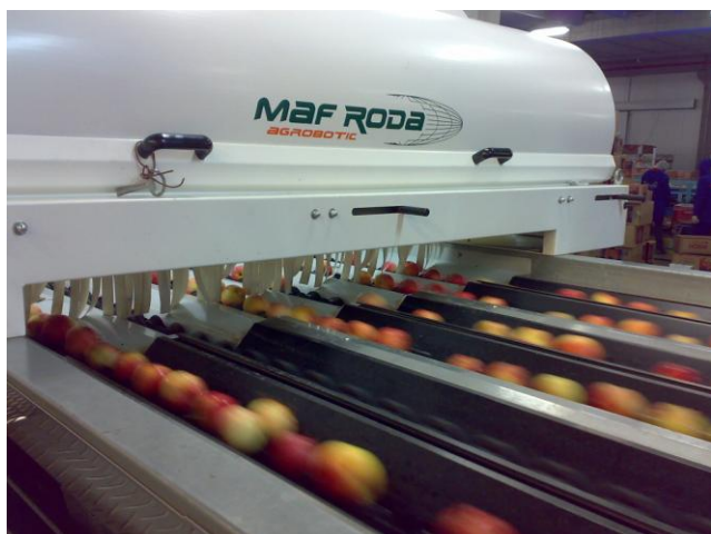
Figura 11. Câmara óptica de pré-classificação com esteiras de maçãs em movimento. Fonte: Betina Pereira de Bem (2012)
