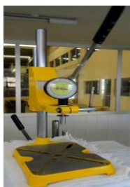
Figura 9. Aparelho penetrômetro para medida de firmeza de polpa (lbs). Fonte: Betina Pereira de Bem (2012).
