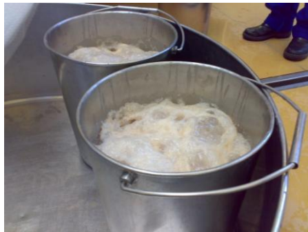
5) Adição da solução do ativante (Actmax) nos baldes com a levedura, agitação e formação de espuma.
