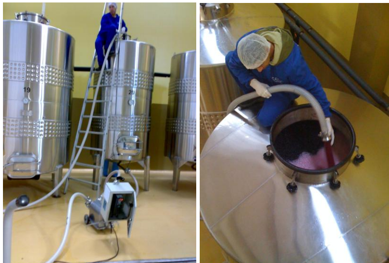
Figura 20. Remontagem em circuito fechado. À esquerda bomba conectada na parte inferior do tanque, impulsionando o líquido para cima pela mangueira; à direita operador lançando o líquido em forma de chuveiro sobre o chapéu. Fonte: Betina P. de Bem (2012)
