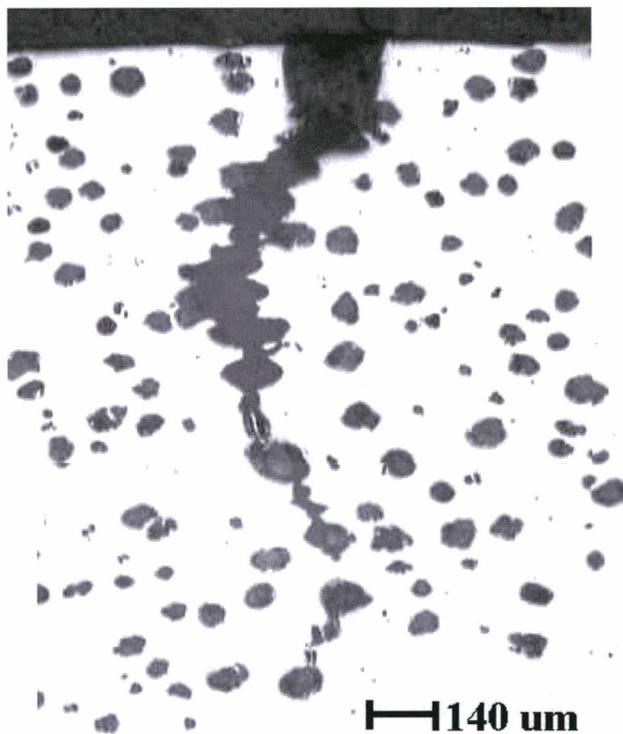
**Figura 99** - Micrografia mostrando o bloqueio de uma microtrinca.
