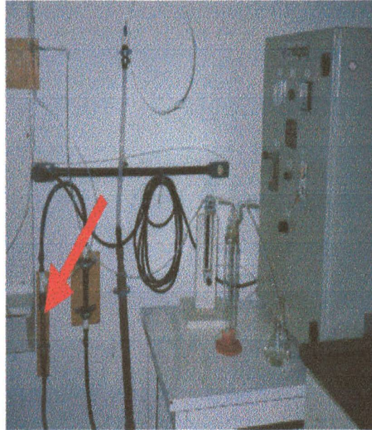
Figura 19 – Piloto de ozonização com misturador estático
