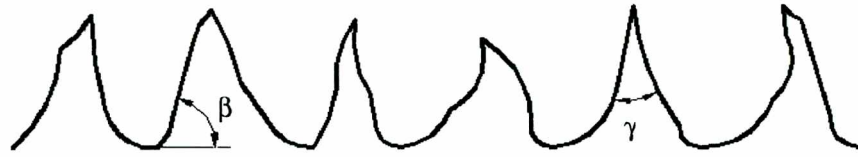
Figura 6.6: Elevações com ângulo de pico ( \gamma ) pequeno e ângulo de inclinação ( \beta ) grande.
