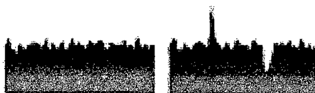
Figura 2.7: Superfícies com mesmo valor de R_a e diferentes valores de R_y [19].
