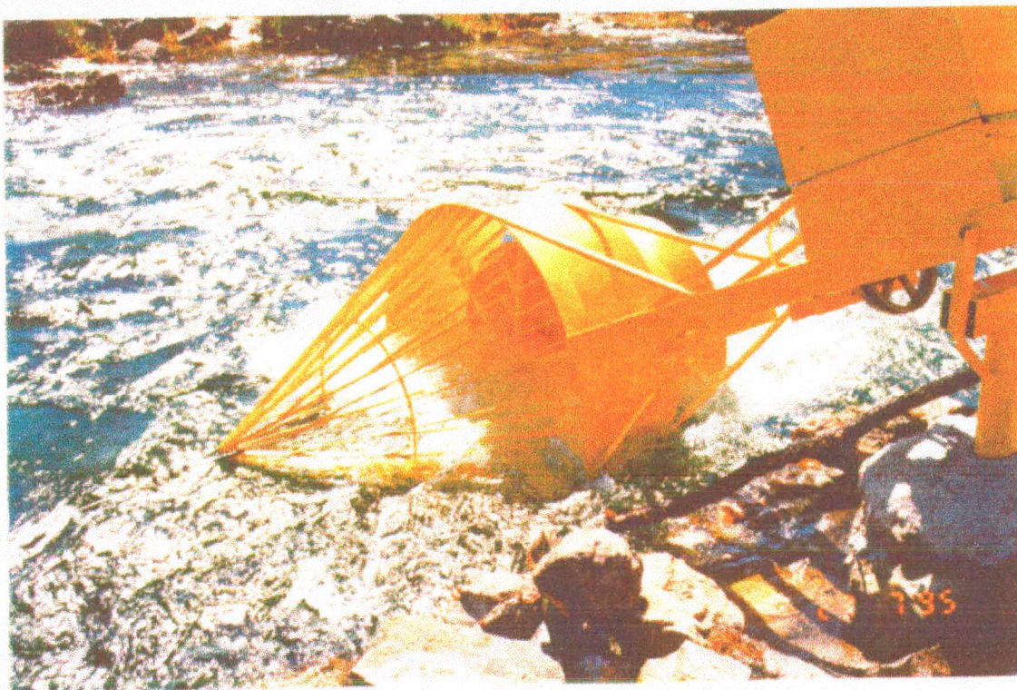
Figura 2.7- Turbina hidrocínética - Protótipo desenvolvido pela UnB. Fonte: Nascimento et al., 1999
