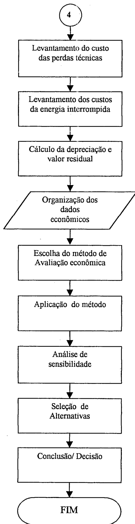
Figura 5.12- Fluxograma para avaliação técnico-econômica de sistemas elétricos
