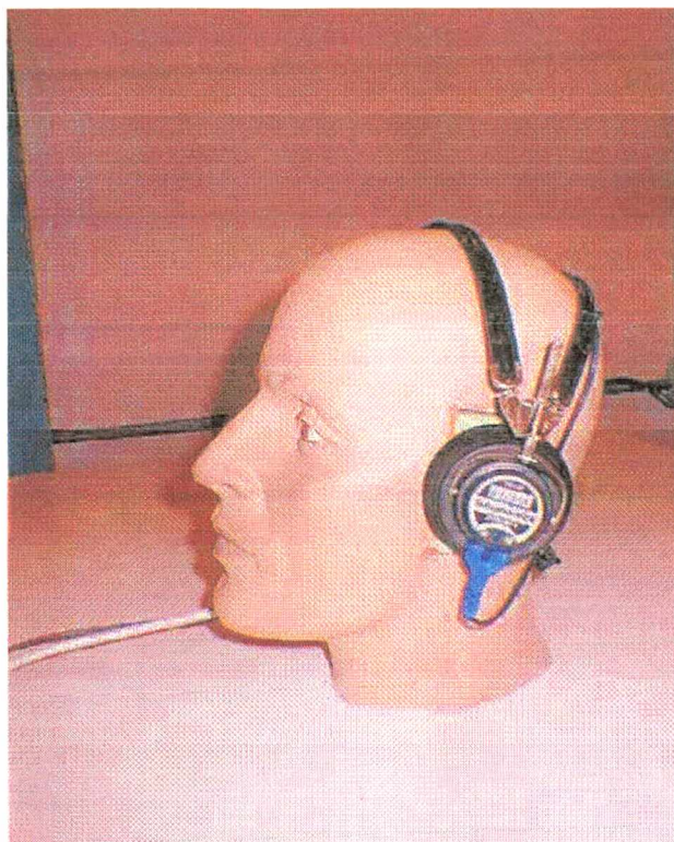
Figura 6.2 – Cabeça Artificial durante a Execução dos Testes Audiométricos, no Interior da Cabina Acústica com o Fone TDH 39 Adaptado ao Molde Esquerdo
