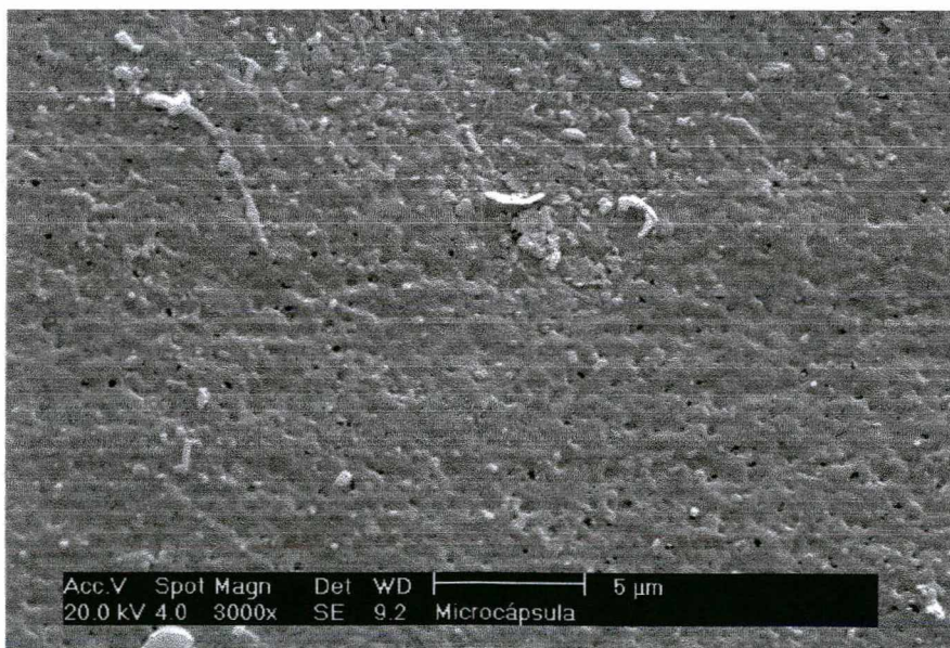
Figura 26 – Detalhe da superfície da microesfera M1c .
