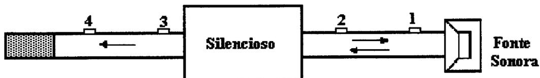
Figura 35 – Esquema dos pontos de medição
