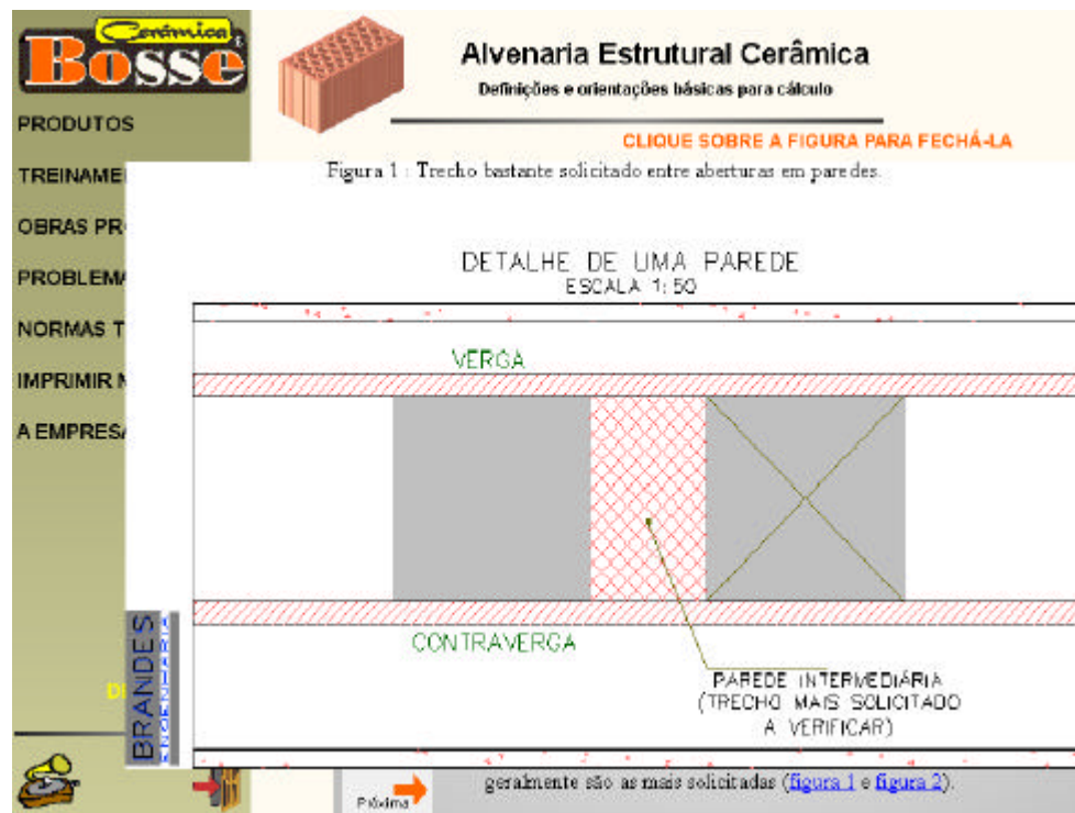
Figura 20: Detalhe de verga e contra-verga feitas com canaleta cerâmica "U"
