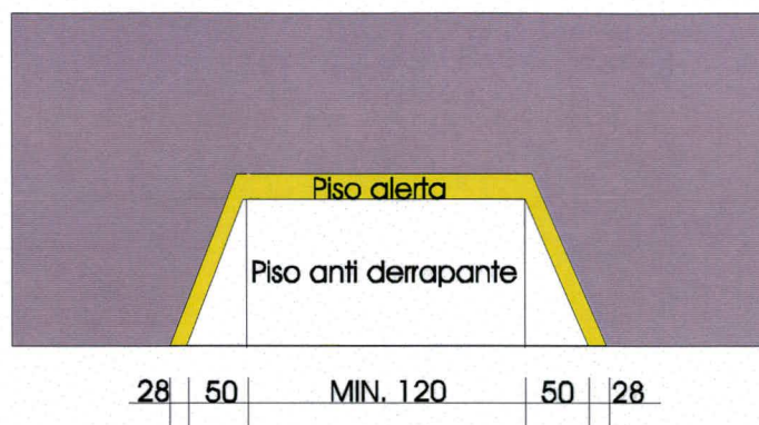
Figura 7.25 – Rampas em Passeios – Dimensões.
