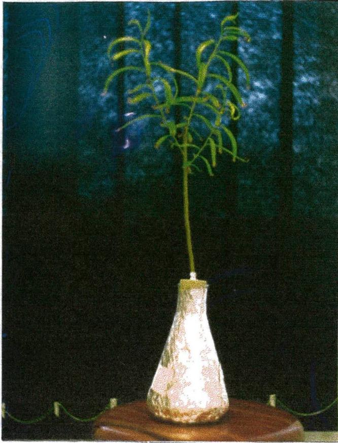
Figura 13 Reator com estaca de *S.babylonica* em fase de enraizamento. O mesmo modelo de reator foi utilizado para os experimentos de absorção direta do nitrato e do etanol e também para os experimentos de fitotoxicidade.
