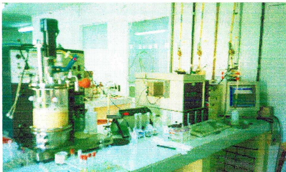
**Figura 2.3** – Biorreator BIOFLO III, New Brunswick Co. e cromatógrafo CG 90 com microcomputador acoplado para integração das curvas cromatográficas.
