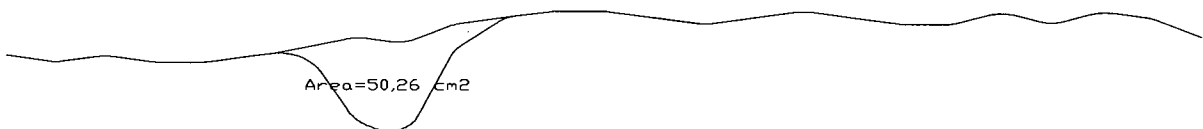
Figura 4. 12 Perfil transversal do solo mobilizado pelo sulcador da semeadora.
