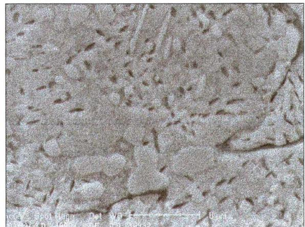
**FIGURA 52** – Microestrutura da zona de difusão do ferro nitrocementado a 700 °C. Ataque nital modificado I.
