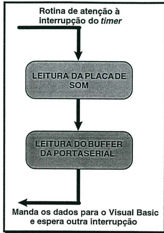
Figura 27 - Rotina de aquisição programada usando a interrupção do timer do computador
