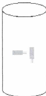
**Figura 3.6** Posição dos Strain-gauge no corpo-de-prova cilíndrico
