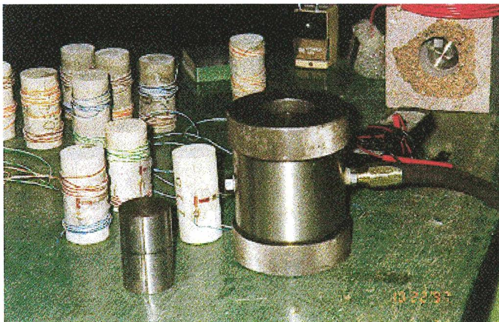
Figura 3.3 Câmara triaxial dimensionada para suportar pressões de confinamento da ordem de 50 MPa
