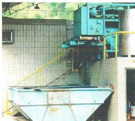
**Figura 2.6** – Coleta do lodo em contêiner na saída do filtro prensa de cinto.
