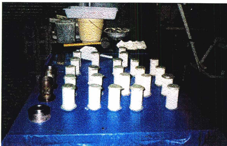
Anexo 3.3 – corpos de prova em argamassa de areia de fundição
