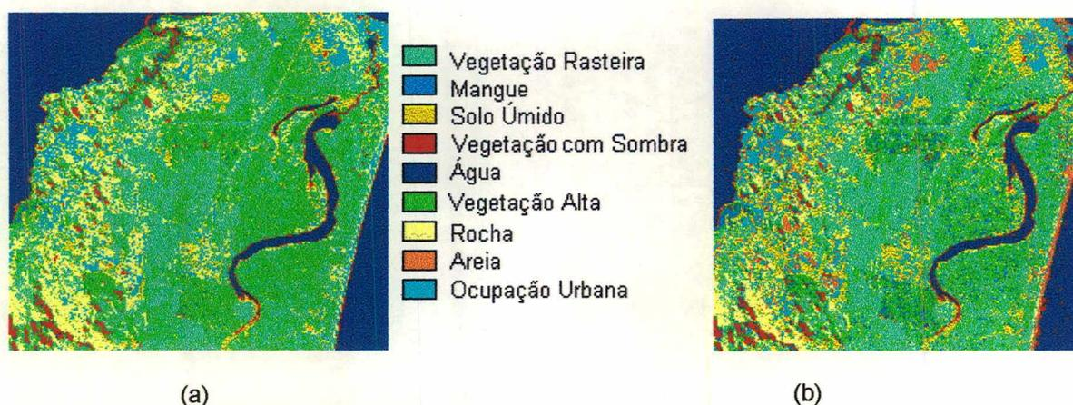
**Figura 4.10:** (a) Imagem classificada com a RBF. 43 centros treinados com aprendizado de kohonen em 130 iterações. Ao centro, a legenda das classes identificadas na região. (b) Imagem resultante da classificação pela Máxima Verossimilhança.
