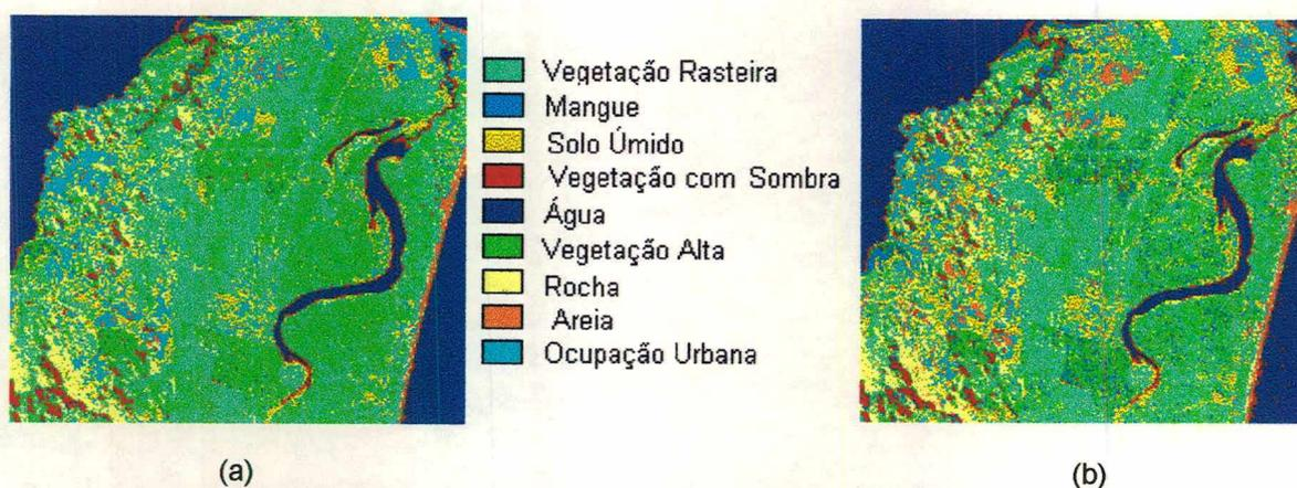
**Figura 4.11:** (a) Imagem classificada com a RBF. 36 centros treinados com o algoritmo das K-médias. Ao centro, a legenda das classes identificadas na região. (b) Imagem resultante da classificação pela Máxima Verossimilhança.
