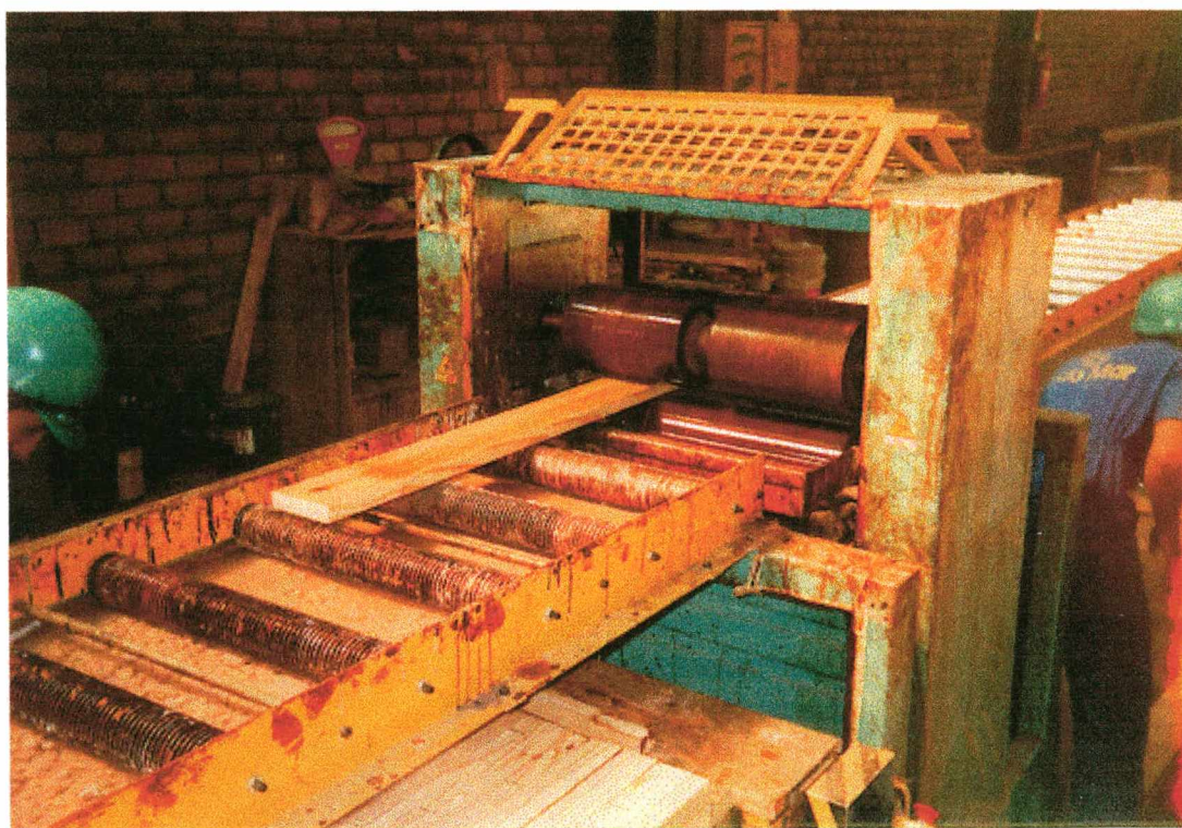
Foto 6.2 Dispositivo de aplicação do adesivo
