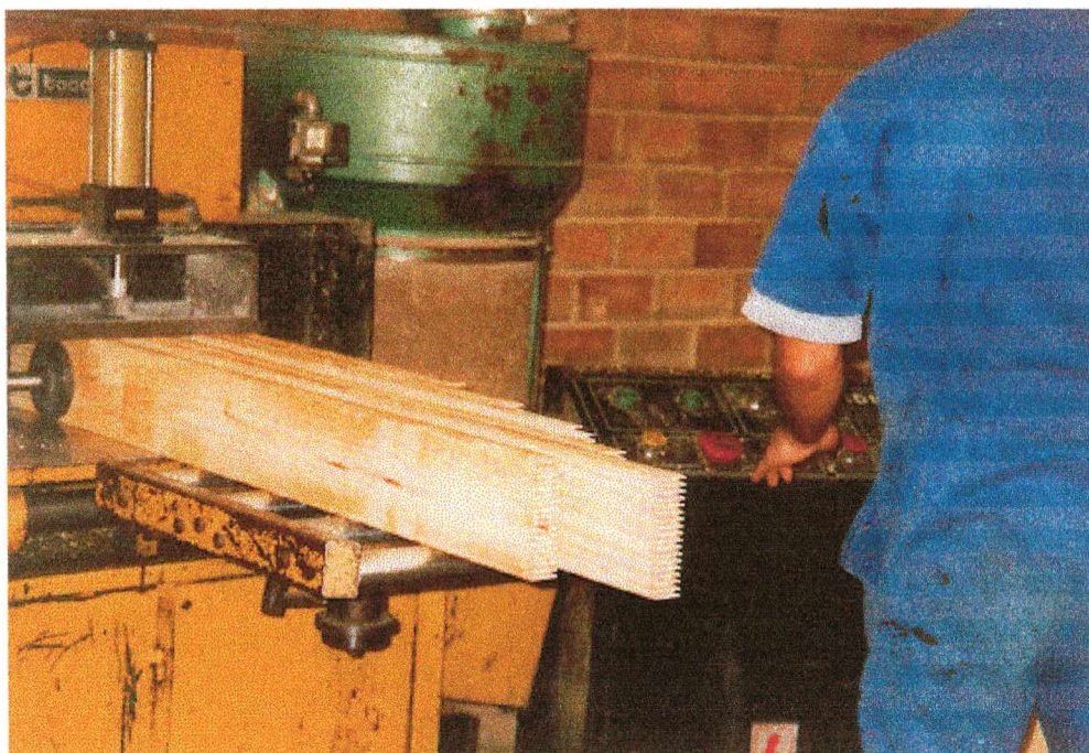
Foto 3.2 Freza TOCCHETO - execução dos entalhes múltiplos.
