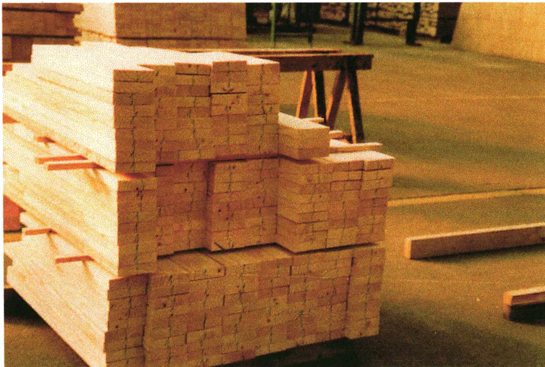
Foto 3.1 Pilhas das tábuas após destopagem.
