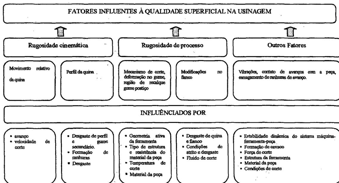
Figura 3-77 - Tabela com fatores influentes na qualidade superficial na usinagem de metais (segundo Betz) [4].
