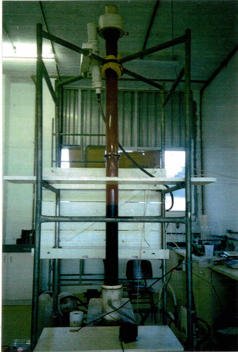
Figura 6. Reator de leito fluidizado trifásico aeróbio.
