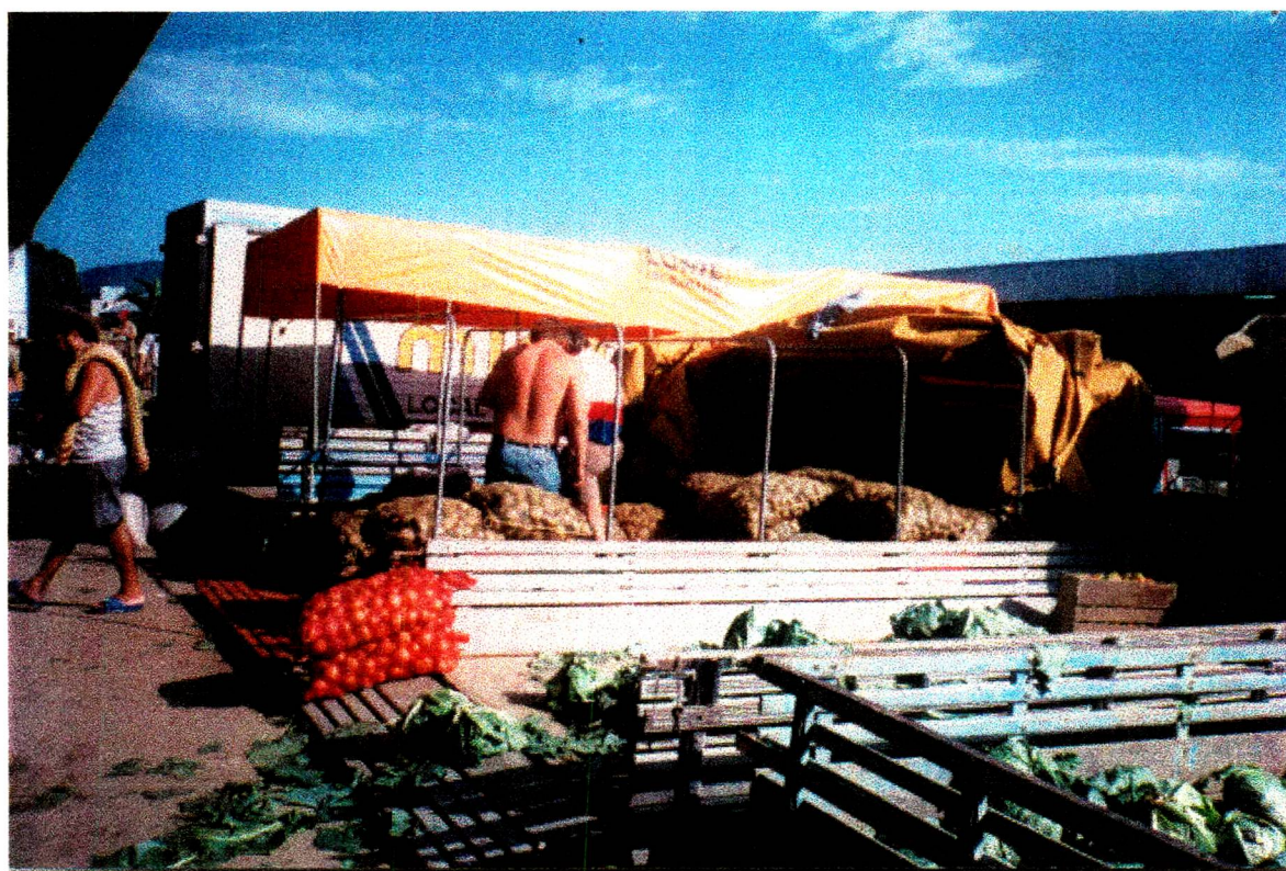
Figura 19 - Proteção da carga: armação de ferro isola a lona das hortaliças, mantendo a qualidade e protegendo do sol e da chuva durante a viagem (Cavicchioli, fev. 1995).
